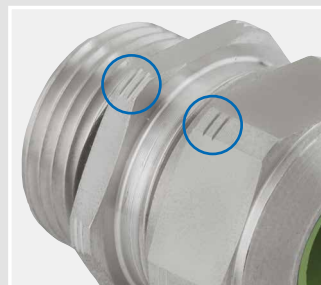
2 Rillen kennzeichnen Stahl A4 . Dichteinsatz in FPM für hohe Temperaturen und Säurebeständigkeit (grün)
