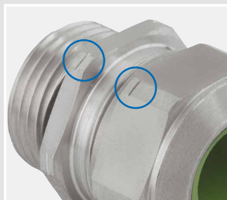
1 Rille kennzeichnet Stahl A2 . Dichteinsatz in FPM für hohe Temperaturen (grün)
